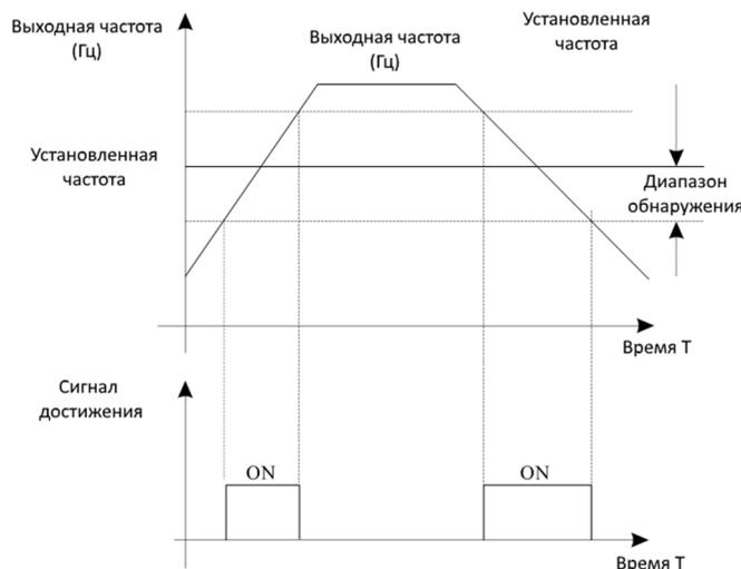
Рис. 5-15 Диапазон обнаружения достигнутой частоты
