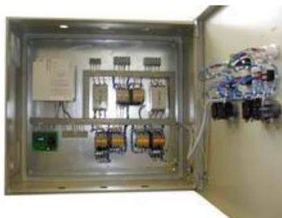
Станция управления предназначена для ручного и автоматического управления группой насосных агрегатов с асинхронными электродвигателями, работающих в системах холодного и горячего водоснабжения, циркуляции отопления, и может работать как составная часть системы электрооборудования тепловых пунктов коммунального хозяйства. Станция обеспечивает поддержание заданного давления (перепада давления) в диктующей точке теплового пункта путем изменения частоты вращения электродвигателя насосного агрегата.
